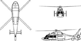
Referenz Hubschrauber Eurocopter Dauphin - AS 365 Länge über alles: 13,68m Rotordurchmesser: 11,94m
