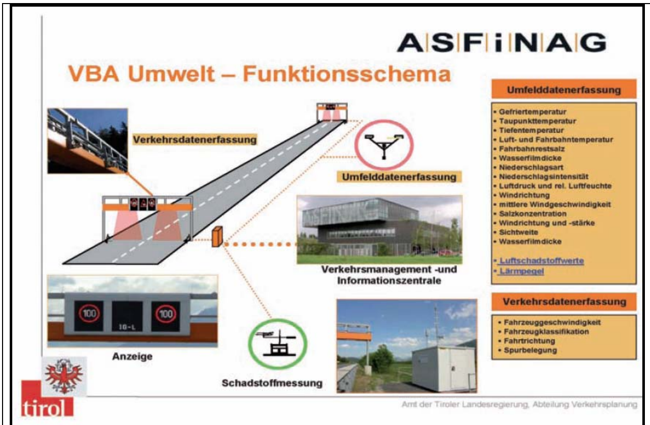
Abbildung 6/2: Funktionsweise der umweltsensitiven Verkehrssteuerung auf der österreichischen Seite des Inntals entlang der Inntalautobahn A 12
